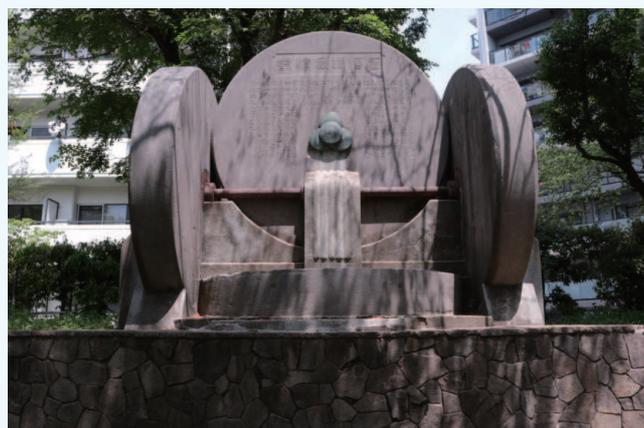
明治9(1876)年、世界でも最新の火薬製造機械だった圧磨機圧輪を利用して、板橋火薬製造所が開設された。現在、圧磨機圧輪はモニュメントとして、加賀西公園(加賀)に残っている。
