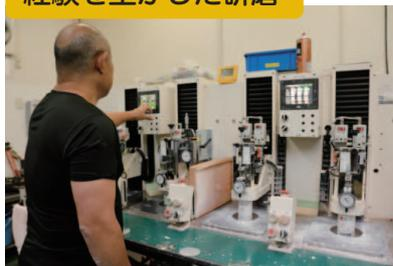
機械によるレンズの研磨（上）では、研磨する時間、研磨剤の種類などの設定に、長年の経験に基づく職人技（右）が発揮される。
