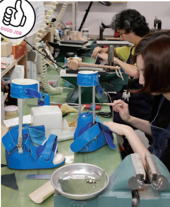
金属支柱付きや、プラスチック製など、一人ひとりの障がいの状態に合わせて作る。
