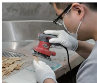
器もフォークも、すべての商品は、機械で大きく切り出した後、職人が手作業で一つひとつ仕上げていく。
