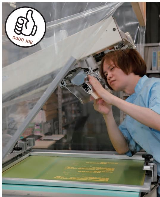
『METALFACE』は、インクを1色ずつ重ねていくシルク印刷で行う。機械だけに任せられない、職人技が必要な技法。
